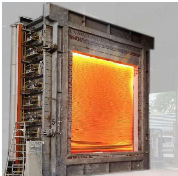
Horno de Ensayo de Resistencia al Fuego
