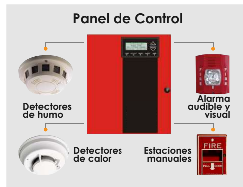
Detector de humo conectado a un panel de control.
