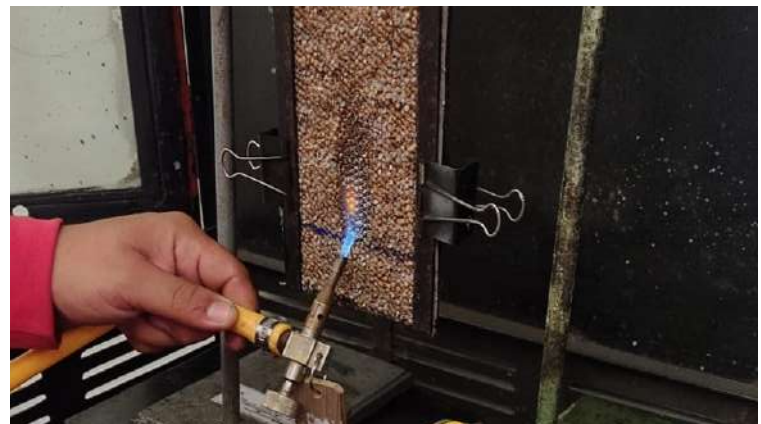
Figura 2: Ensayo de revestimientos textiles. Cortesía División Tecnología de la Construcción de IDIEM
