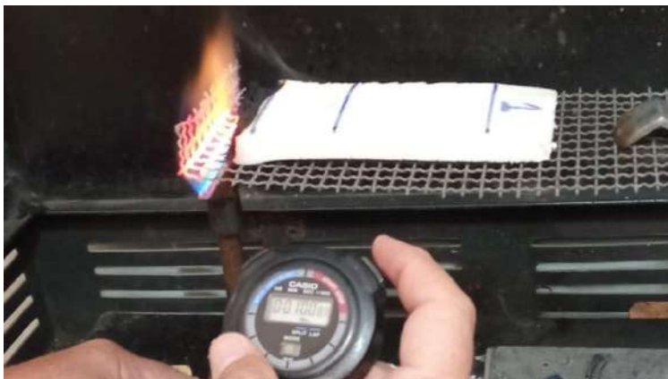
Figura 1: Ensayo de espumas plásticas. Cortesía División Tecnología de la Construcción de IDIEM
