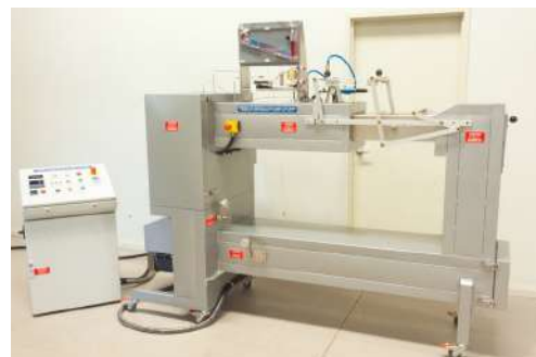
Túnel de prueba de inmersión para determinar RTI.
