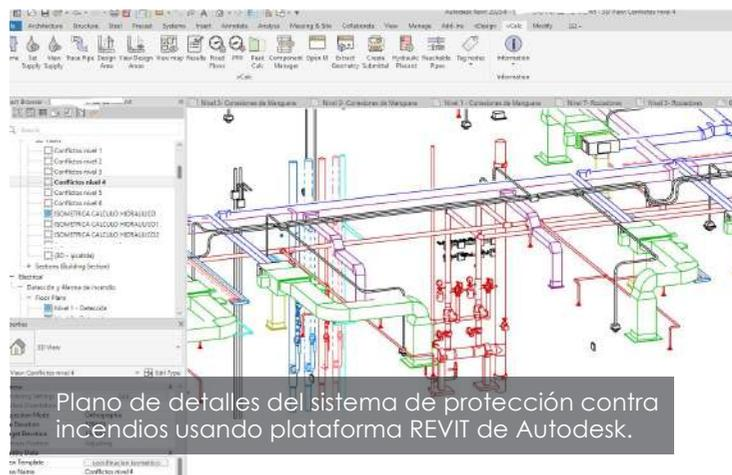
Plano de detalles del sistema de protección contra incendios usando plataforma REVIT de Autodesk.
