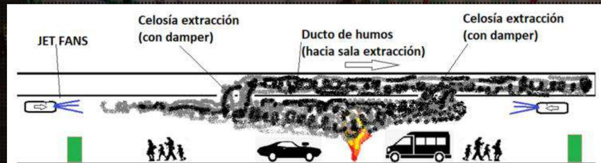
Figura 9 Esquema: Ventilación mixta con jet-fans, ventiladores extracción y celosías de extracción. Incendio
