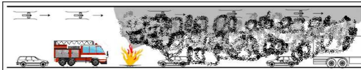
Figura 8 Esquema: Ventilación longitudinal utilizada post-evacuación, labores de ataque del incendio
