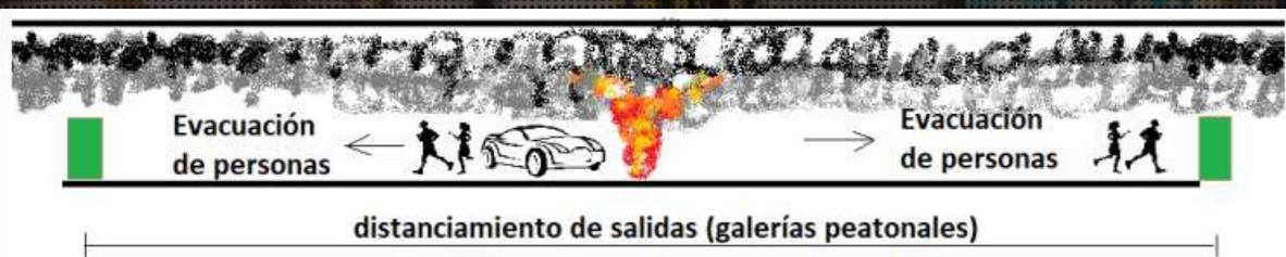
Figura 7 Esquema: Ventilación longitudinal apagada, durante evacuación en caso de incendio
