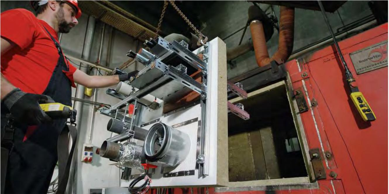
**Figura 11. Ensamble por montar en horno de pared abierta**
