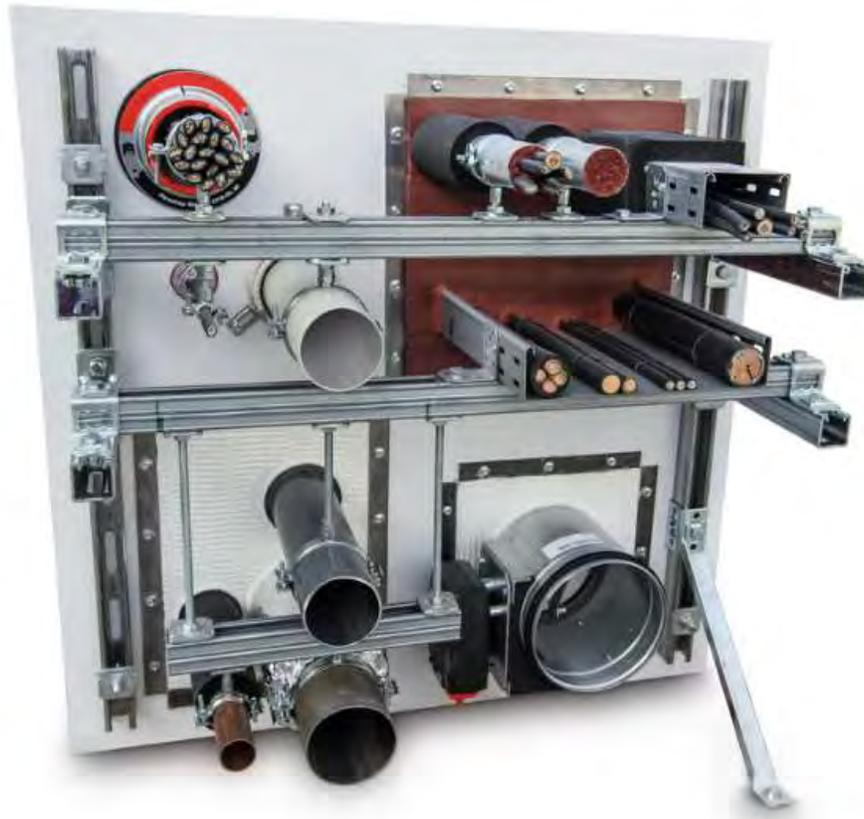
**Figura 10. Ensamble de sistemas a someter a ensayo de fuego**
